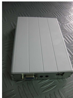
Abbildung 5.1.: Die Testumgebung simbox mit der selben Hardware im Roboter Nao.
