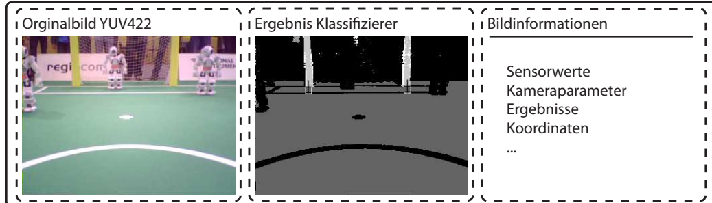
Abbildung 9.1: Das BLD- Bildcontainerformat. Es beinhaltet neben dem Originalbild das klassifizierte Bild und zusätzliche Informationen.
